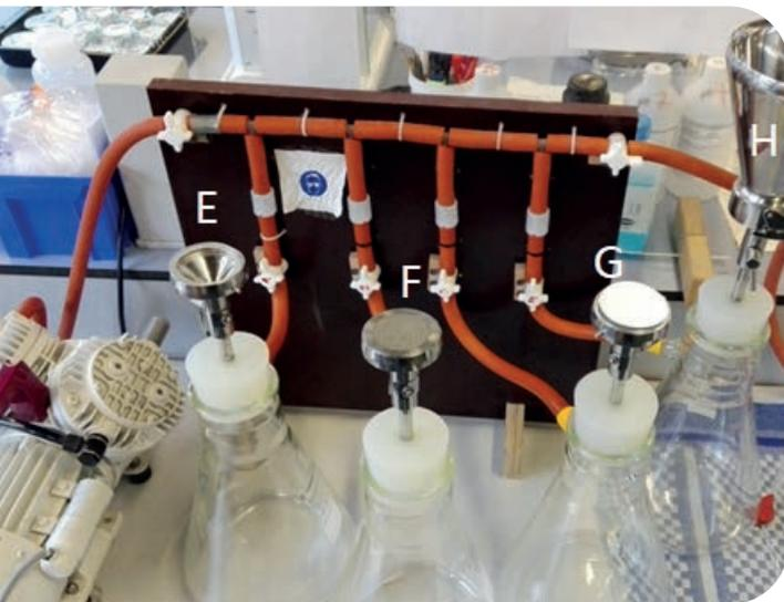
Aufbau der Filtrationsanlage von links nach rechts: 1. Anschluss der Saugflasche 2. Edelstahlstutzen in Saugflasche einsetzen 3. Silikondichtungsrings einsetzen 4. Metallsinterplatte einsetzen 5. Filter mittig auflegen 6. Edelstahl-Kegel aufsetzen und mit Bügel festschnallen:
